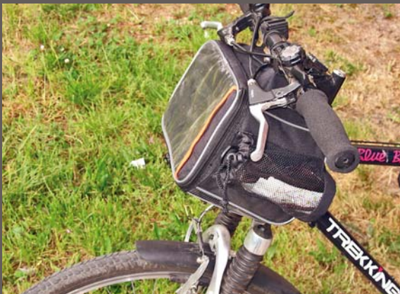
Na uchycení řídítkových brašen stahovací pásky zapomeňme. Zcela sklopená poloha je nejen hůře přístupná, ale mapnik zcela ztrácí smysl, stejně jako kapsy na bidon.
