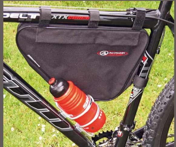
Příliš velká rámová brašna by sice pojala hodně zavazadel, ovšem boční vychýlení kvůli bidonu překáží, a tudíž tato kombinace nepřichází v úvahu.
